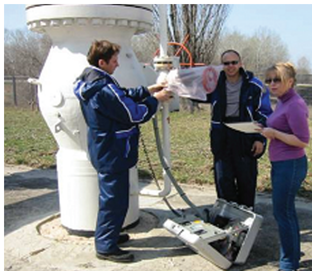
技术员在 Cherkasytransgas 压缩机站用高流量采样器测量甲烷排放泄漏率。
